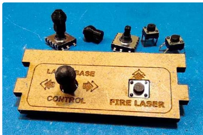
Bild 5. Der (zu) kleine Joystick.
