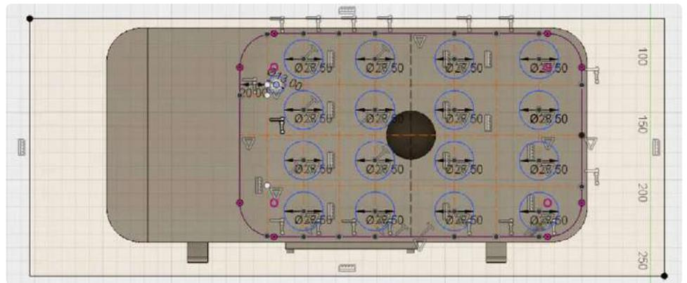
Bild 13. Bohrschablone für die Pflanzen-Halterung.
