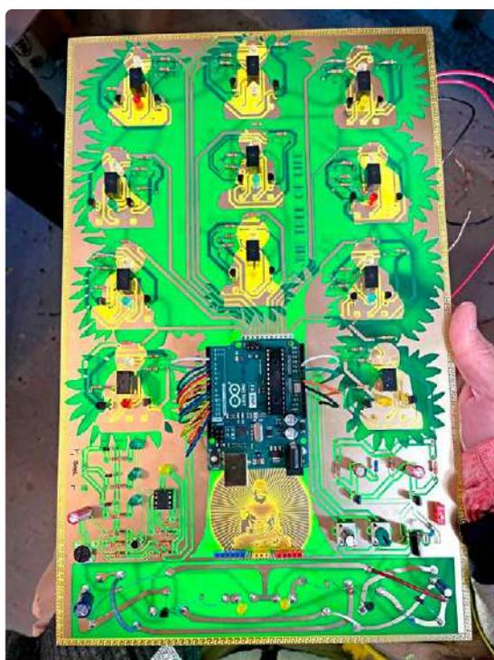
Bild 4. Links der Entwurf für *The Tree of Life* in *The Circuit Garden* (2022), rechts die Platine mit einem integrierten Arduino UNO. (Quelle: Kelly Heaton)
