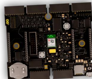
Arduino Edge Control ist eine Fernüberwachungs- und -steuerungslösung, die für den Außenbereich optimiert ist. Sie kann überall platziert werden und eignet sich für Präzisionslandwirtschaft, intelligente Landwirtschaft und andere Anwendungen, die eine intelligente Steuerung an entfernten Standorten erfordern. Die Stromversorgung kann entweder über ein Solarpanel oder eine Gleichstrombuchse erfolgen.
