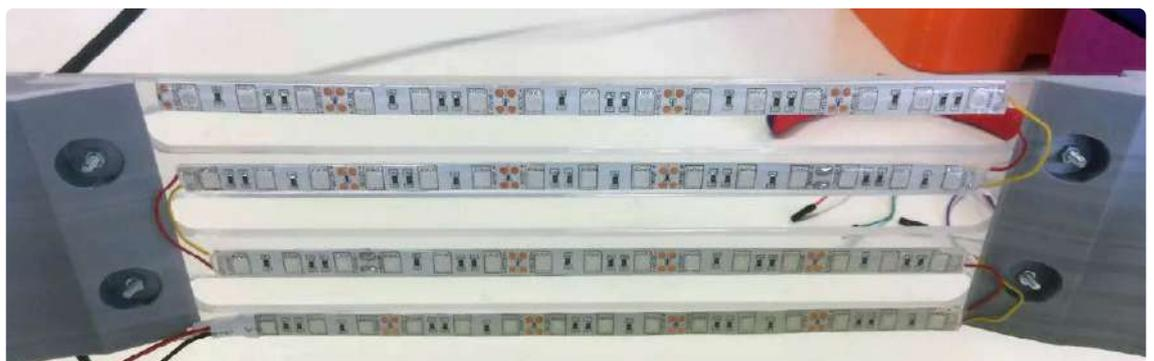
Bild 14. Die verwendeten RGB-LED-Streifen.
