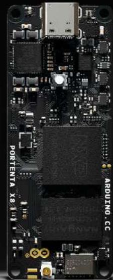
Bild 1. Das Arduino-Board Portenta X8.
