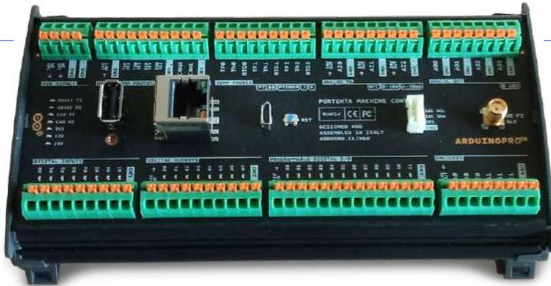
Bild 2. Klemmleisten des Boards Arduino Portenta Machine Control.
