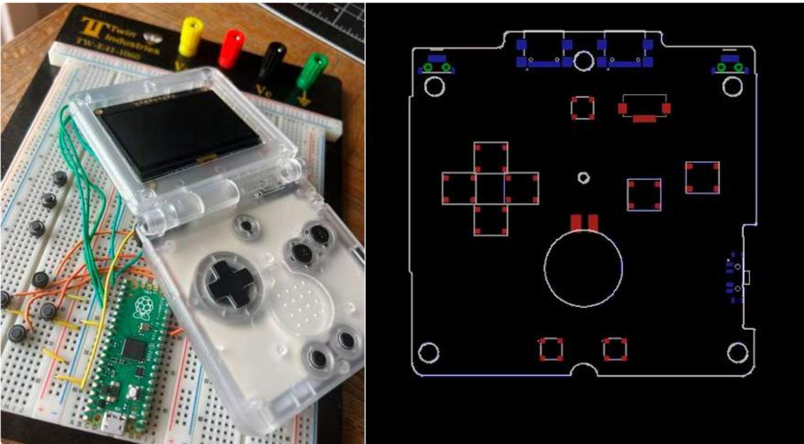
Bild 8. RP2040-betriebene Konsole.
