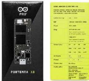
Portenta X8 ist ein leistungsstarkes, industrietaugliches SOM mit vorinstalliertem Linux-Betriebssystem, das dank seiner modularen Container-Architektur geräteunabhängige Software ausführen kann. Es handelt sich im Grunde um zwei Industrieprodukte in einem, die die Verfügbarkeit von Arduino-Bibliotheken und -Fähigkeiten mit einer Container-basierten Linux-Distribution kombinieren.
