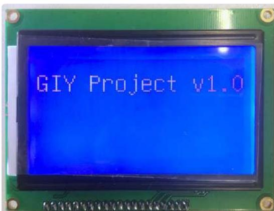
Bild 9. Das verwendete LCD hat eine Auflösung von 128x64 Pixeln und ist über nur drei Pins mit der Platine verbunden.
