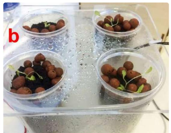
Bild 4. 3D-gedruckte Netzschalen (a) und fertig montiertes Testsystem (b).
