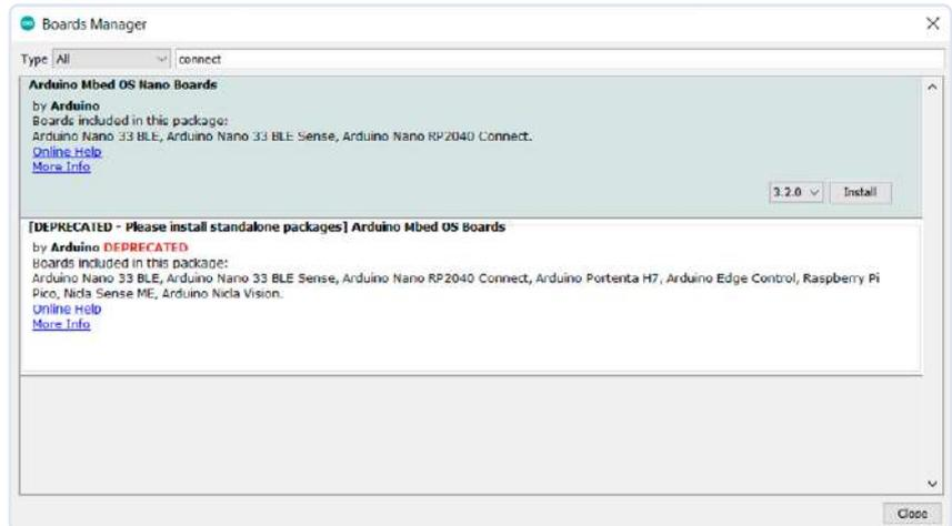
Bild 3. Verwenden Sie den Boardverwalter der IDE, um die Unterstützung für den Arduino Nano RP2040 Connect zu installieren.
