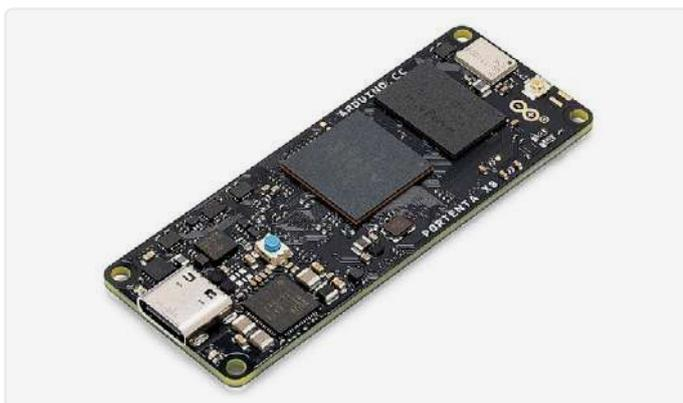
Bild 1. Portenta X8 ist ein leistungsfähiges, industrietaugliches SOM mit vorinstalliertem Linux-Betriebssystem, das dank seiner modularen Container-Architektur geräteunabhängige Software ausführen kann.
