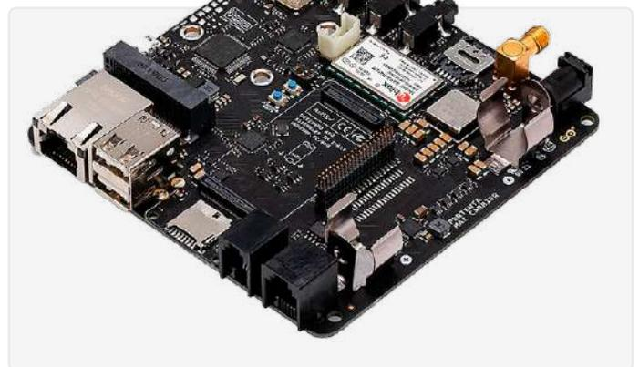
Bild 2. Max Carrier verwandelt Portenta-Module in Einplatinencomputer oder Referenzdesigns, die Edge AI für Hochleistungsanwendungen in der Industrie, Gebäudeautomatisierung und Robotik ermöglichen.
