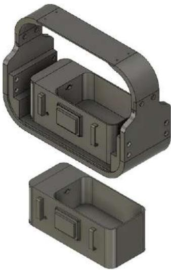
Bild 12. Kompletter Aufbau von Gehäuse und Wasserbehälter.
